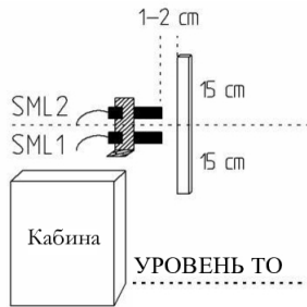
Рисунок -14: Установка магнитов для датчиков точной остановки SML1-SML2
