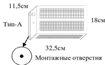
Рисунок-3: Установочные размеры для тормозных резисторов Типа-А и Типа-В
